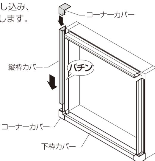
③残りのコーナーカバーに上枠カバーと残りの縦枠カバーを差し込みます。
